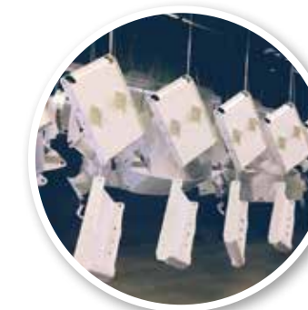
Alle Komponenten werden sandgestrahlt, grundiert und pulverbeschichtet.
