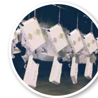
Alle deler er stanset, primet og pulverlakkert
