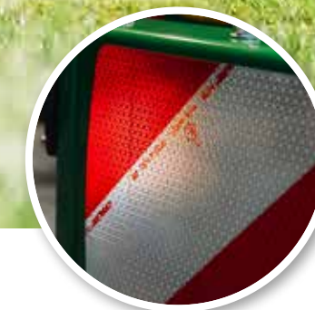
Rød-hvite paneler i henhold til standard (ECE-104)
