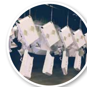
Alla delar är blästrade, grundmålade och pulverlackerade
